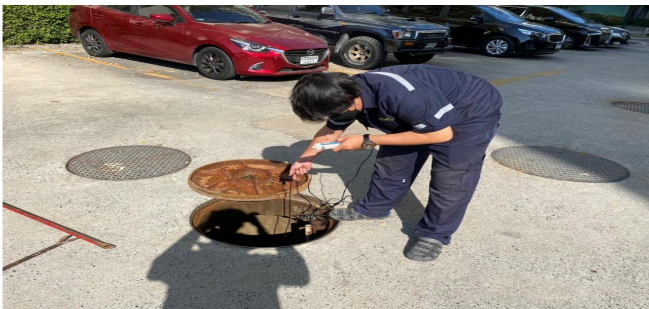
รูปที่ 14 ดำเนินการตรวจวัดค่า DO ป่อเติมอากาศระบบบำบัดน้ำเสีย Plant 1-4
